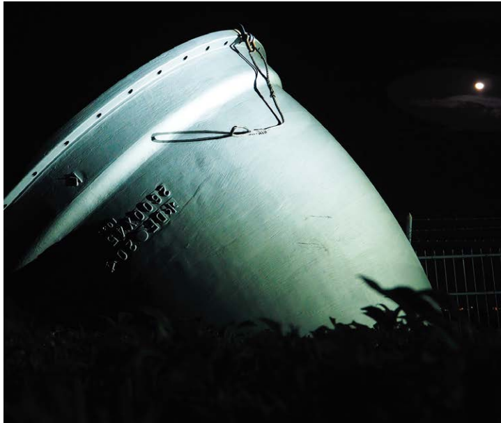
今回搬入した鉄管(K形 曲管 φ2600x45°)。
