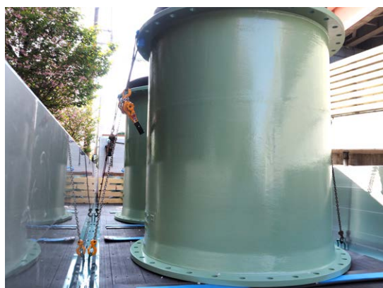
距離が遠いときには、休憩時に点検・増し締めを行う。 最初の増し締めの時は、緩んでいることが多い。
