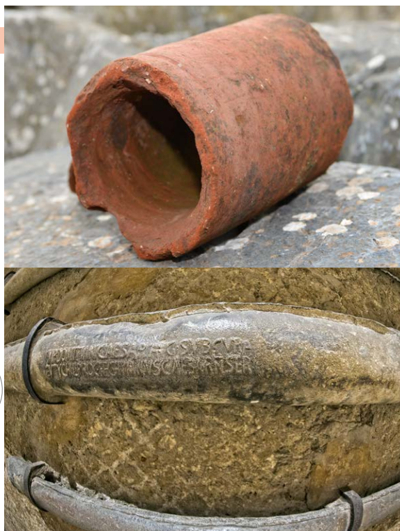
上)陶でできた水道管 下)鉛管。溶接の跡が分かる。
