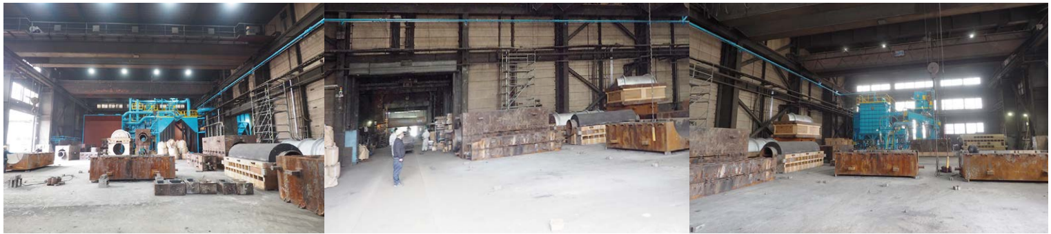
広大な鑄込みスペースの両端に置かれた設備。左)奥に解体～再生機。元々デッドスペースになっていた場所に設置。中)壁に圧送パイプが走る。右)奥にミキサー。ホッパーが巨大な事が分かる。
