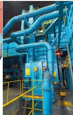
再生機。10t/hが2機ある。インバーター制御で適正なイグロス値を自動で保ってくれる。砂が汚かったら洗浄するが、洗いすぎるとダストが発生する。砂が固まらないなどの造形不良が起きなくなった。
