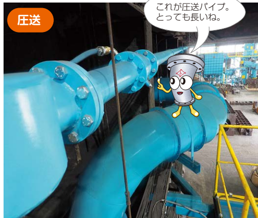
再生砂をエアで圧送パイプ(上の細いパイプ)を通してミキサーへ運ぶ。以前よりも圧送距離自体も短くなり使用するエアも減った。
