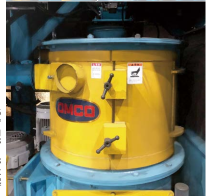
再生機。10t/hが2機ある。インバーター制御で適正なイグロス値を自動で保ってくれる。砂が汚かったら洗浄するが、洗いすぎるとダストが発生する。砂が固まらないなどの造形不良が起きなくなった。
