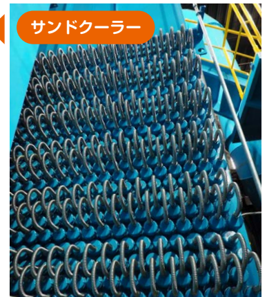
解体、再生した砂は熱いので、サンドクーラーで冷やす。何本もの細い管の中を水が通っている。
