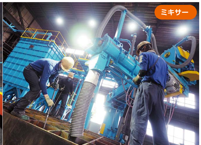
(左上)ミキサーに繋がっているホッパー。再生機から圧送パイプまでが止まっても、ミキサーを止めないために容量をできるだけ大きくした。(左下)再生された砂はコンベアでミキサーへと送られる。(右)ミキサーで砂を鑄型に流し込む。ミキサーの砂を排出する速度が以前の1.5倍(30t/h)になり作業スピードが格段にアップ。また、ミキサー全体の大きさが大きくなり、大きな口径の水道管にも対応できるようになった。さらに、砂を排出するアームの旋回範囲も広がり、造形スペースも広くなったので、同時進行できる枠数が増えた。
