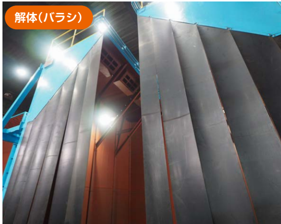
解体スペース。解体した砂は自動で地下に落ちていくので、以前のように砂が山積みになる場所がなくなり、作業場を広く使えるようになった。
