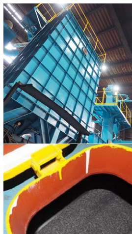
(左上)ミキサーに繋がっているホッパー。再生機から圧送パイプまでが止まっても、ミキサーを止めないために容量をできるだけ大きくした。(左下)再生された砂はコンベアでミキサーへと送られる。(右)ミキサーで砂を鑄型に流し込む。ミキサーの砂を排出する速度が以前の1.5倍(30t/h)になり作業スピードが格段にアップ。また、ミキサー全体の大きさが大きくなり、大きな口径の水道管にも対応できるようになった。さらに、砂を排出するアームの旋回範囲も広がり、造形スペースも広くなったので、同時進行できる枠数が増えた。
